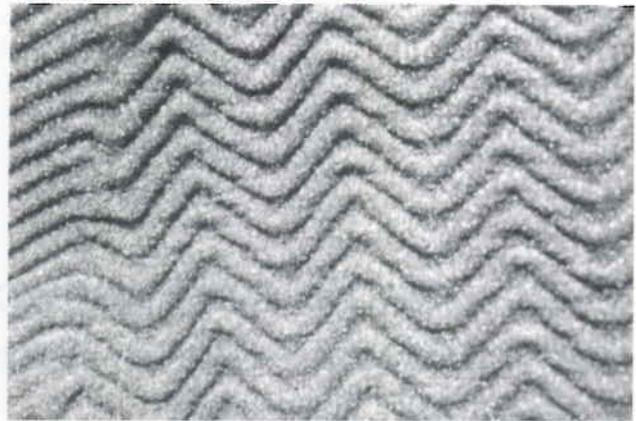
Fig. 1. - Aspetto della superficie interna della guaina con la particolare tessitura a rilievo.
